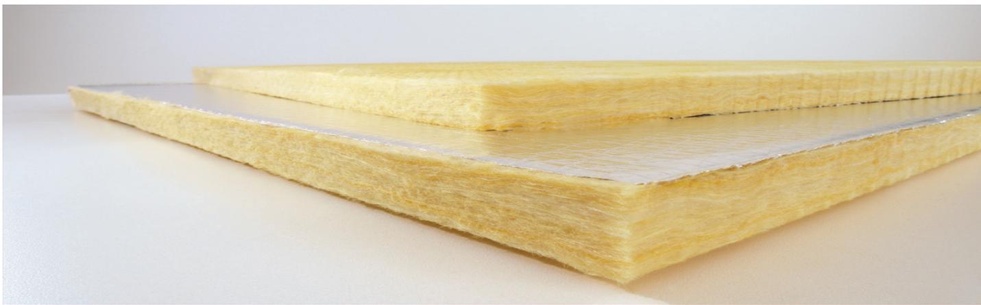
**AK BOARD<sup>MD</sup>** est un produit d'isolation thermique et acoustique composé de fibres de verre inorganiques liées par une résine thermodurcissable. Il est offert sous forme de panneau, avec ou sans chemisage de type FSK ou tout usage (ASJ) appliqués en usine.
